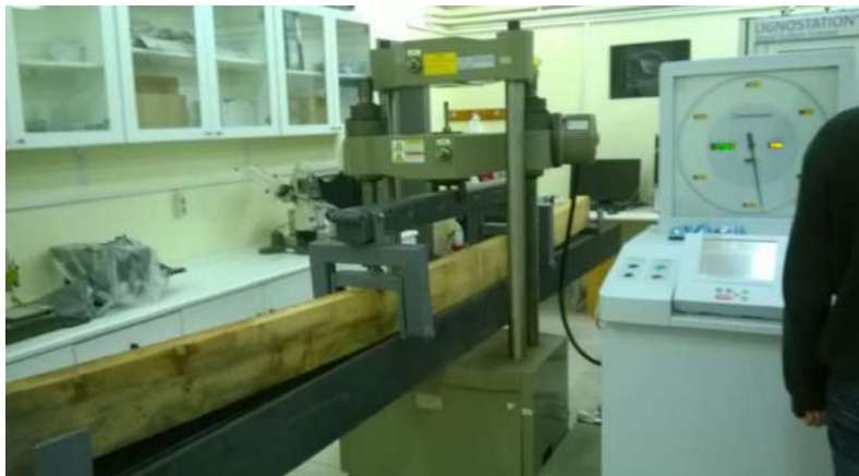
Εικόνα 2. Η μηχανή δοκιμών στο Εργαστήριο Τεχνολογίας Ξύλου. Picture 2. Destructive test device in Wood Technology Lab.
