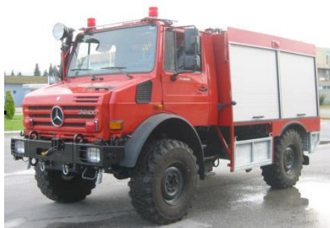
Σχήμα 8. Τυπικό δασοπυροσβεστικό όχημα (UNIMOG συμπαραγωγή της ΕΛΒΟ).
